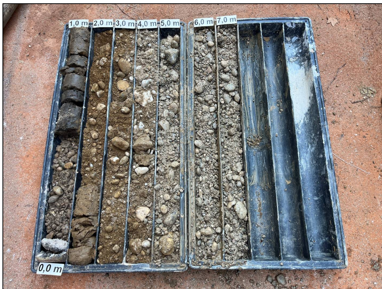
Slika 4. Prikaz jezgre temeljnog tla iz geotehničke istražne bušotine B-2
