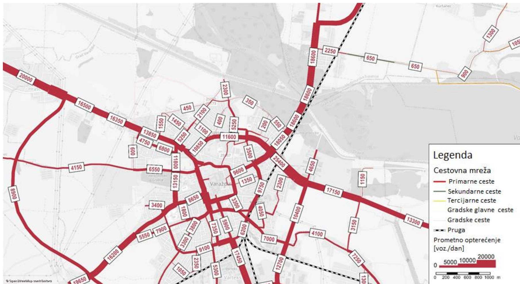
Grafički prikaz D-15: Prometno opterećenje, Varijanta V1 (bliže Varaždinu) u 2040. g. [vozila/dan]
