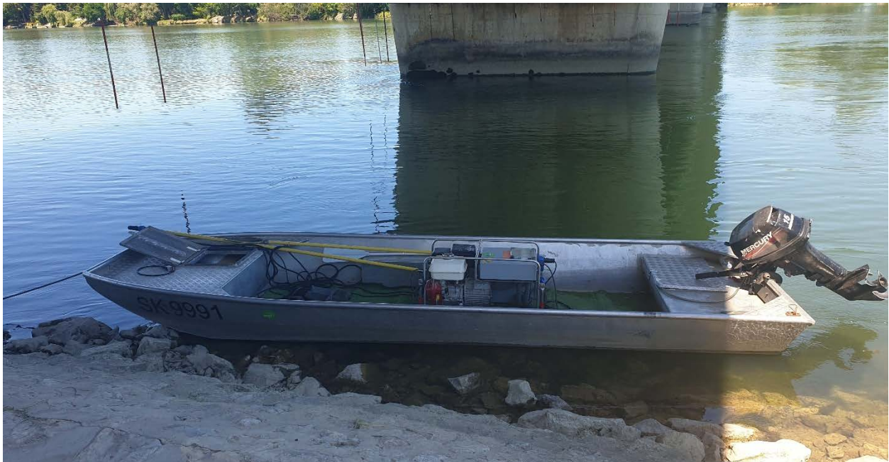
Slika 10. Aluminijski čamac s benzinskim motorom i električnim stacionarnim agregatom Hans-Grassl EL63 II GI izlazne snage 6,5 kW za elektroribolov, slikan ispod Mosta hrvatskog bana Josipa Jelačića
