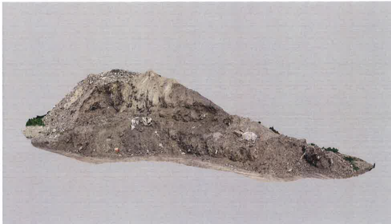
Prikaz 3D modela deponije na sjevernom dijelu čestice dobiven geodetskom fotogrametrijskom izmjerom (pogled sa jugoistoka)
