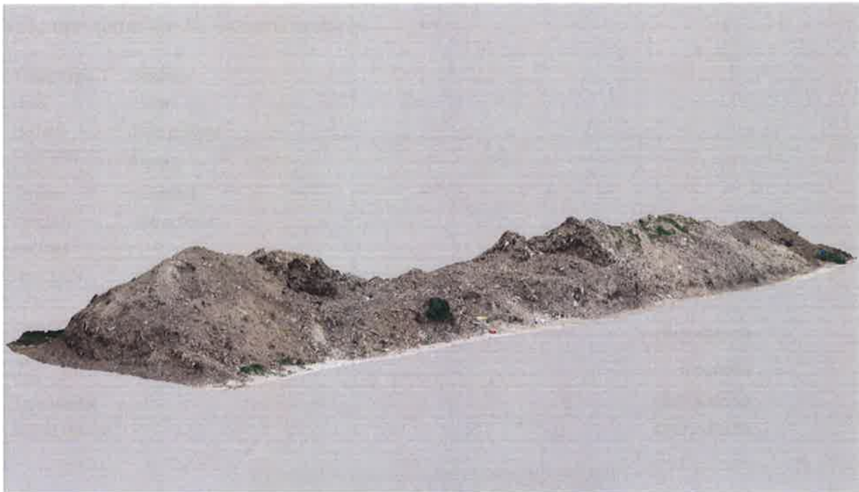
Prikaz 3D modela deponije na južnom dijelu čestice dobiven geodetskom fotogrametrijskom izmjerom (pogled sa sjeveroistoka)
