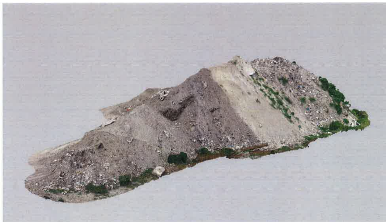
Prikaz 3D modela deponije na sjevernom dijelu čestice dobiven geodetskom fotogrametrijskom izmjerom (pogled sa jugoistoka)
