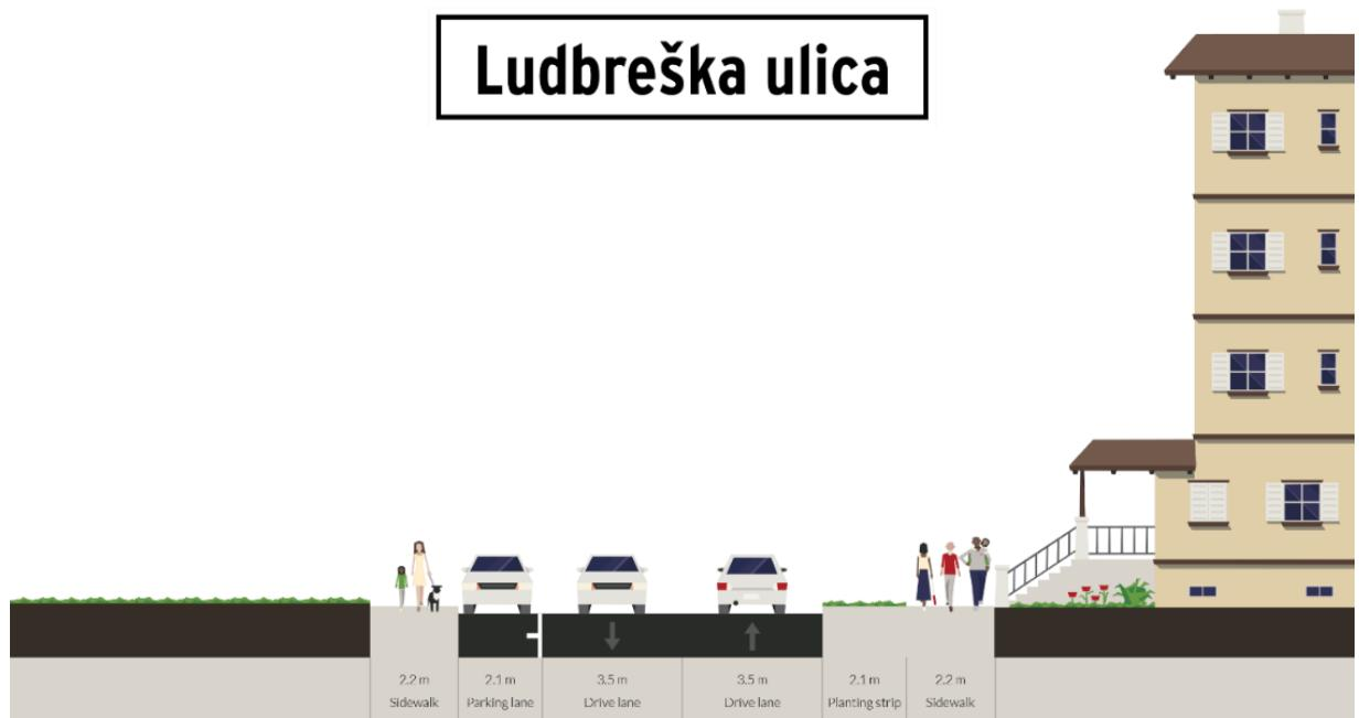
Slika 51. Poprečni presjek Ludbreške ulice
