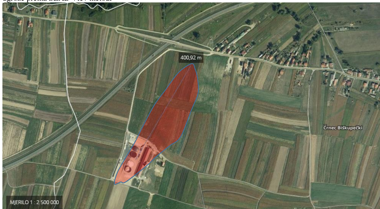
Slika 38: Lokacija Bioplinskog poduzeća i radijus ugroze u slučaju akcidenta na rezervoarima eko plina -radijus ugroze prema SLAB View metodi
